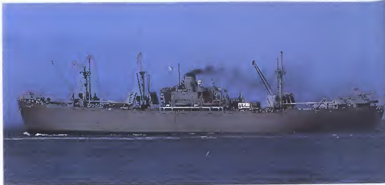
Λίμπερτυ του αμερικανικού πολεμικού ναυτικού, με πλήρη οπλισμό, συμμετέχει σε νηοπομπή. Κατά τη διάρκεια του πολέμου τα λίμπερτυ ήταν εξοπλισμένα με οκτώ ΑΣΑ, ένα πυρηνόλο των 76mm μπροστά και ένα πυρηνόλο των 127mm πίσω.
