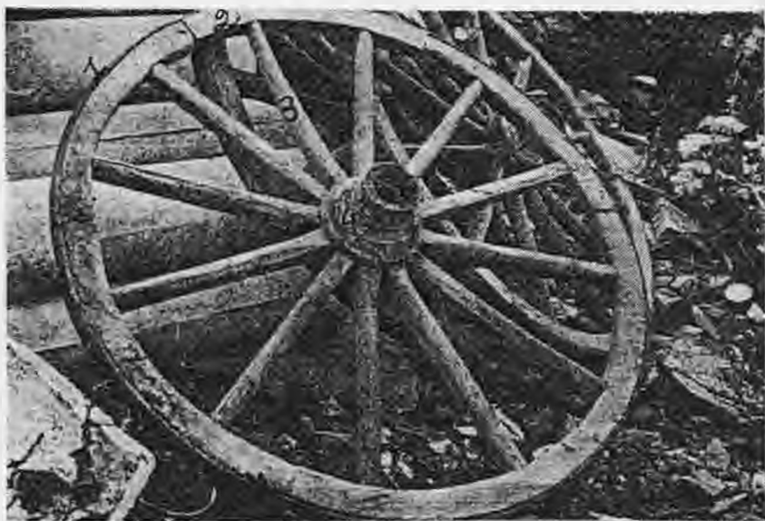
Φουτ. 1. Η όξου μιριά του τρούκουλα 1. Του στιφάνι 2. Οι αψίδεις ή ταμπόνια 3. Τα παρμάκια (ακτίνεις) 4. Κιφαλάρι 5. Στιφάνι 6. Τρύπα που σθαίνει η ματ- μένια πουριά.
