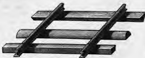
7. Σύστημα έγκορσίων στρωτήρων.
