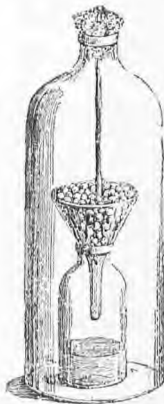
Εἰκ. 195. Συσκευὴ πρὸς κατὰδειξιν τῆς αὐτοθερμάνσεως τῶν σπερμάτων. Αὐτὸ τοῦ ἐκ βάμβακος πώματος τοῦ ἐξωτερικοῦ κώδωνος κατέρχεται θερμόμετρον, οὕτως τὸ σφαιρίον κεῖται ἐντὸς τῶν σπερμάτων.
