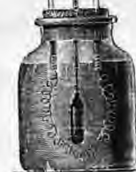
12. Ανάπτυξις θερμότητος δι' ηλεκτρικού ρεύματος.
